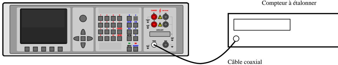
Le calibrateur peut être utilisé pour l'étalonnage de base des oscilloscopes. Le calibrateur comporte les fonctions suivantes :
