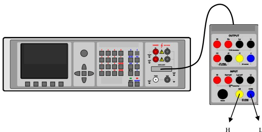
Le multimètre permet la mesure de faibles tensions continues entre 0 et 2 V. Un adaptateur de câble 140-41 est nécessaire. Le signal à mesurer est envoyé sur les bornes Hu/+mV et Lu/-mV. Lu/-mV est la borne commune du multimètre. Pour activer la mesure, sélectionnez le mode de fonction mVDC à l'aide de la touche METER dans le menu de la fonction, puis appuyez sur INPUT pour mesurer la valeur d'entrée.
