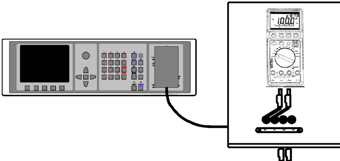
La bobine en option peut porter la gamme de courant du calibrateur à 1 000 A. La bobine peut être utilisée pour l'étalonnage des ampèremètres à courant continu ou alternatif. Les pinces de l'ampèremètre doivent être positionnées de manière à former un angle de 90° avec la bobine. Lors de l'utilisation de la bobine, aucun objet en acier ou magnétique ne doit être présent à proximité (50 cm), car il déformerait le champ magnétique et provoquerait une erreur d'étalonnage importante.
